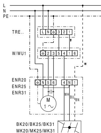
TRE 5-Stufentransformator (Ein/Aus, 5 Drehzahlen)
